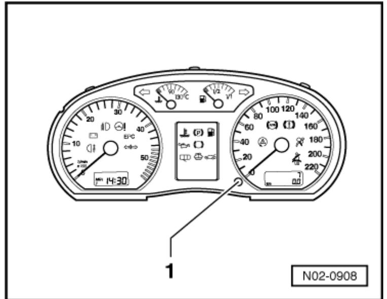
ディスプレイ表示 -1- **注:** または -2- **注:** ディスプレイ ユニット -1- (車両の装備仕様によって異なる) 上で “Service IN” が表示されるか “SERVICE SINCE” が表示されるか、または ディスプレイ ユニット -2- 上で、“ワークショップのシンボル” または “時計” のマークが表示される。サービス時期が経過している場合には、更に “マイナス記号” によってそのことが表示される。
